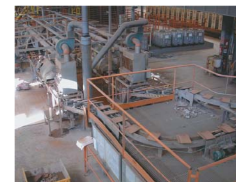
7 Barvení: Tašky poté dostanou povrchovou úpravu ve formě tekuté hlíny smíchané s požadovanou barvou.
