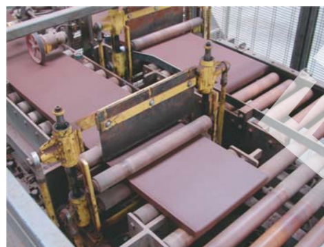
4 Na cestě z extruderu k lisům se pás hlíny rozkrájí na obdélníky. Každý pás hlíny takto produkuje 30 kusů u modelu HP 10 a 50 kusů u modelu Beauvoise.
