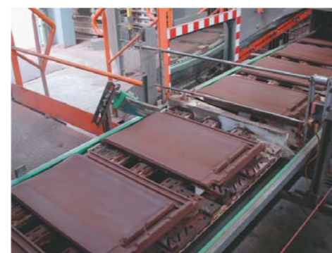
6 Sušení: sušící cyklus představuje 18 hodin pro HP 10 a Beauvoise. Celkem je 5 sušících komor, každá s místem pro 20 sušících rámu. Do rámu se vejde 572 tašek HP 10 a 1152 tašek modelu Beauvoise.
