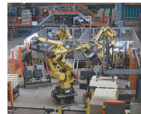
10 Paletizace: Tašky se vážou popruhy a nakládají se na palety.
