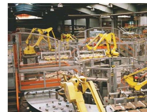
8 Kolotoč: Zde se plní suché tašky do kazet. Ty se poté nakládají na vozy a směřují do pece. Na opačné straně roboti vykládají vypálené tašky z vozů.
