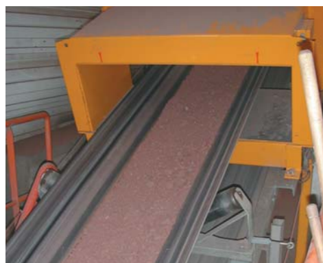
2 Hlína je dovezená ke zpracování na páscech, kde je připravená na proces výroby
