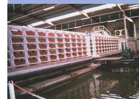
9 Vypalování: Závod v St. Germer de Fly má 17 hodinový cyklus vypalování, během kterého dosáhne teplota až 1120°C. Pec je typu Ceric hydro casing a funguje na zemní plyn.
